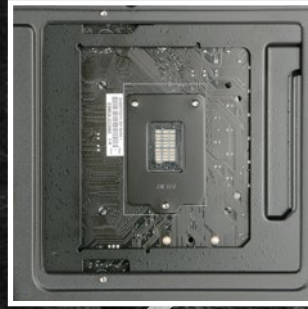
Installationsöffnung für CPU-Kühler
