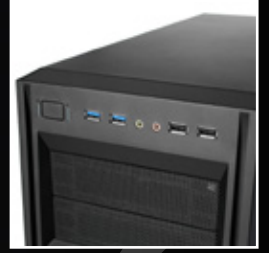
前置 I/O: 2 個 USB 3.0, 2 個 USB 2.0, 2 個 Audio
