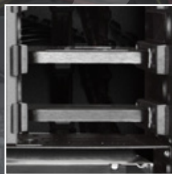
HDD/SSD 滑軌式安裝
